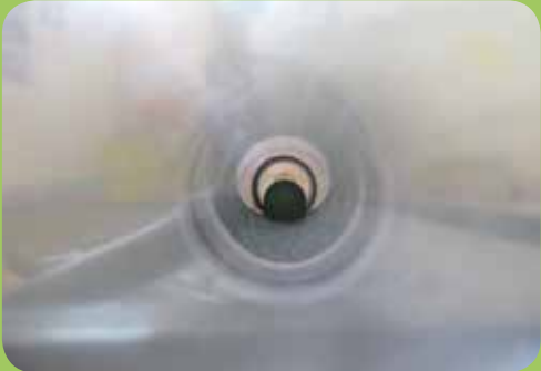
AQUÍ VA PASSAR QUE HI HAVIA UN ESGLAÓ AL MIG I PER AIXÒ ES VA QUEDAR PARADA DINS EL TUB.
