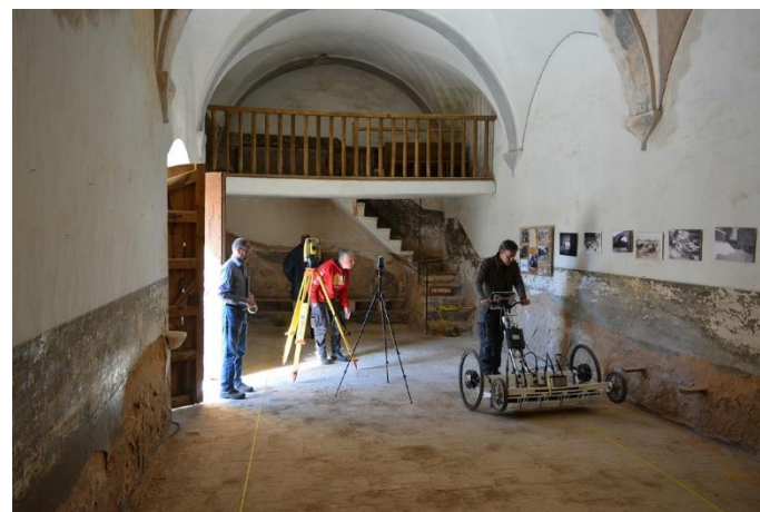
Prospecció amb georadar a l'interior
