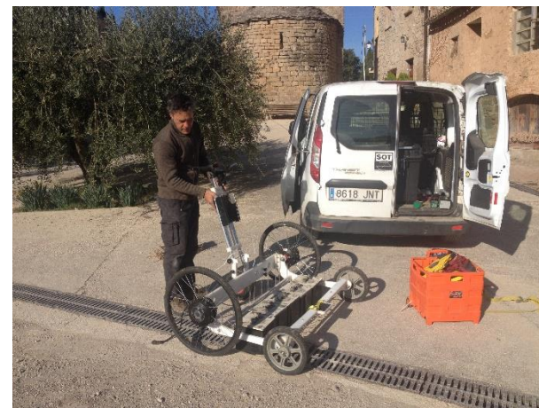
Prospecció amb georadar a l'exterior
