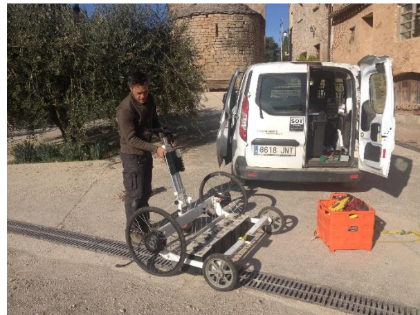
Prospecció amb georadar a l'exterior
