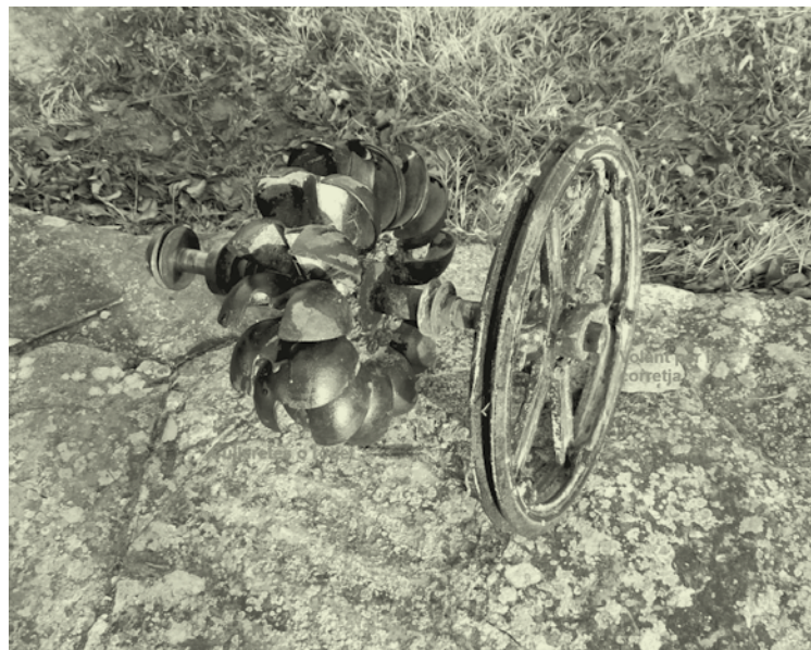
Turbina (dissenyada, fosa i muntada pels avis del Gelabert a mitjans del segle XX)
